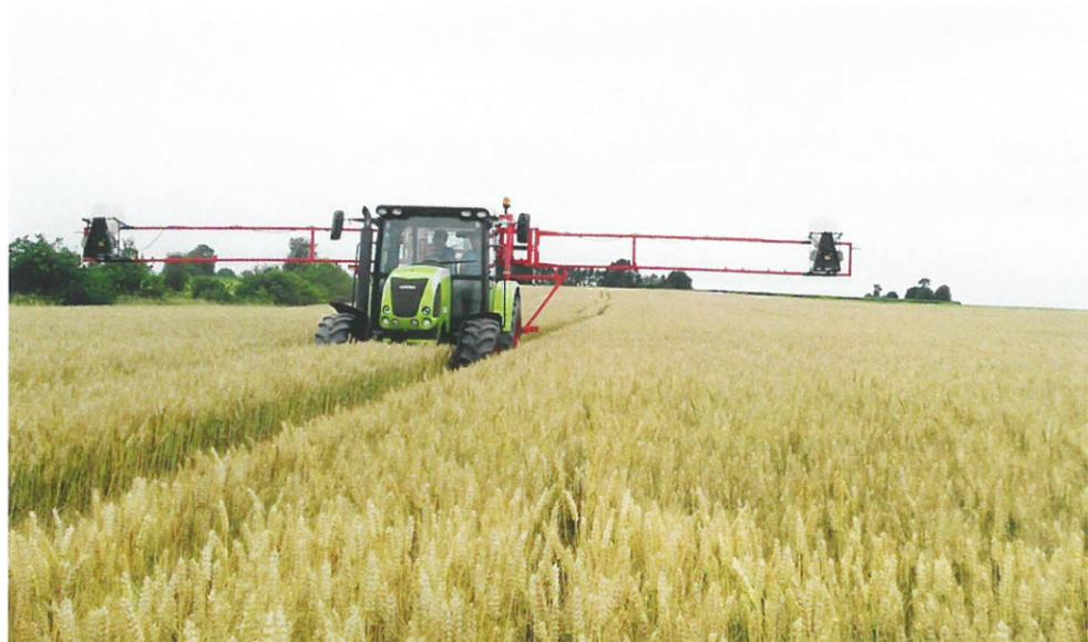
Pour semer au Maxi Couv' avant la moisson, une bâche plastique est installée sous le tracteur pour éviter d'égrainer les épis. La largeur de semis est réglable à 18, 21 ou 24 m.
