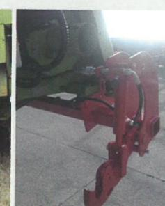
La dernière version du semoir embarqué sur moissonneuse-batteuse comprend des disques Sulky et une roue de rappui. La ligne est fixée sous le convoyeur et peut être relevée si on souhaite moissonner sans semer. La troisième photo montre le système d'accroche.
