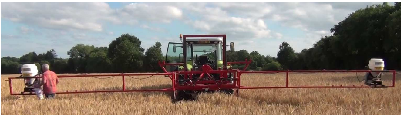
Position remplissage des semoirs. La rampe et le relevage du tracteur sont abaissés.
