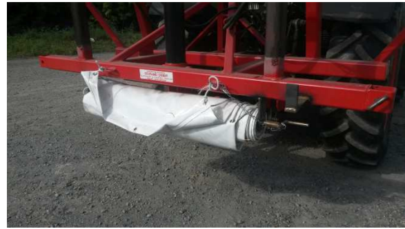
Position route (ici entre 2 parcelles). La bâche peut se replier sur l'enrouleur pour les longs trajets
