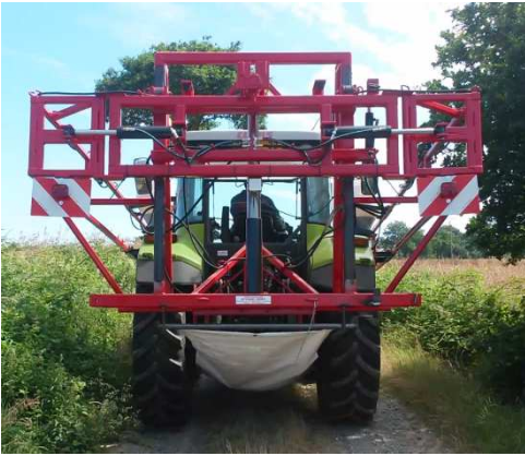
Position route (ici entre 2 parcelles). La bâche peut se replier sur l'enrouleur pour les longs trajets
